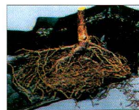
根による貫通、せん孔は認められない。
